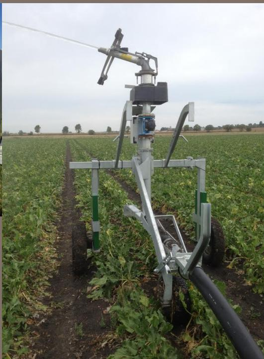
Un dispositif électronique permet de connaître la position du traineau et de programmer l'angle du canon souhaité et sa portée.
